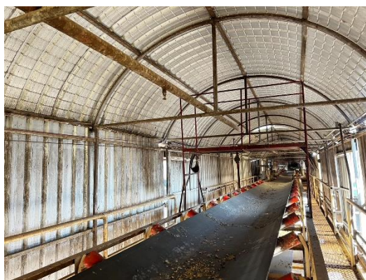
รูปที่ 9 ฝาท่อและหัวฉีดน้ำ บริเวณสายพานลำเลียงขนถ่าย
